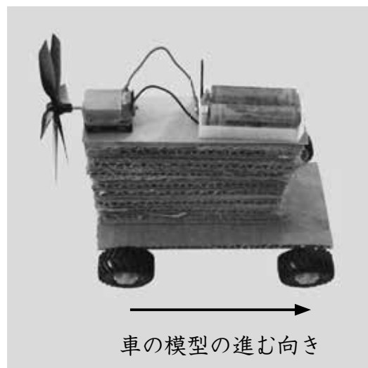
図1 風を起こして走る車の模型
